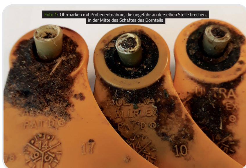
Foto 1: Ohrmarken mit Probenentnahme, die ungefähr an derselben Stelle brechen, in der Mitte des Schaftes des Dornteils
