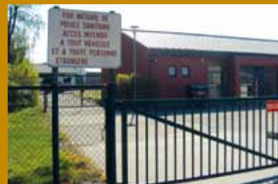
Beispiel « externe Biosicherheit »: Die Umzäunung (mit dem Gatter) begrenzt den Bereich des Betriebs, verhindert den Zugang von streunenden Tieren und kontrolliert den Zugang von Personen und Fahrzeugen. Der Drahtzaun ist solide, eingegraben und 1m50 hoch. Er befindet sich etwa 5 m von den Gebäuden entfernt (Quelle IFIP-ITP)
